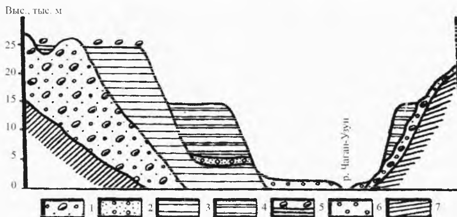
Рис. 134. Сводный поперечный разрез долины р. Чаган-Узунa ниже пос. Кызыл-Мань: 1 – морена; 2 – флювиогляциальный галечник; 3 – ленточные отложения первой толщи; 4 – ленточные отложения второй толщи; 5 – плащ грубообломочного материала; 6 – аллювиальный галечник; 7 – коренные породы склонов долины
